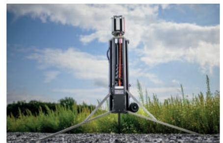
Die im Gehäuse integrierten Standfüße lassen sich mit einem Griff auf dem Boden ablegen. Durch eine Zugbewegung des Mastkörpers nach oben rasten die Füße so ein, dass der Lichtmast auch im unebenen oder schiefen Gelände immer senkrecht steht. Das gewährleistet eine hohe Standsicherheit. Ein zeitaufwendiger Auf- oder Abbau eines Stativs entfällt vollständig. ▶
